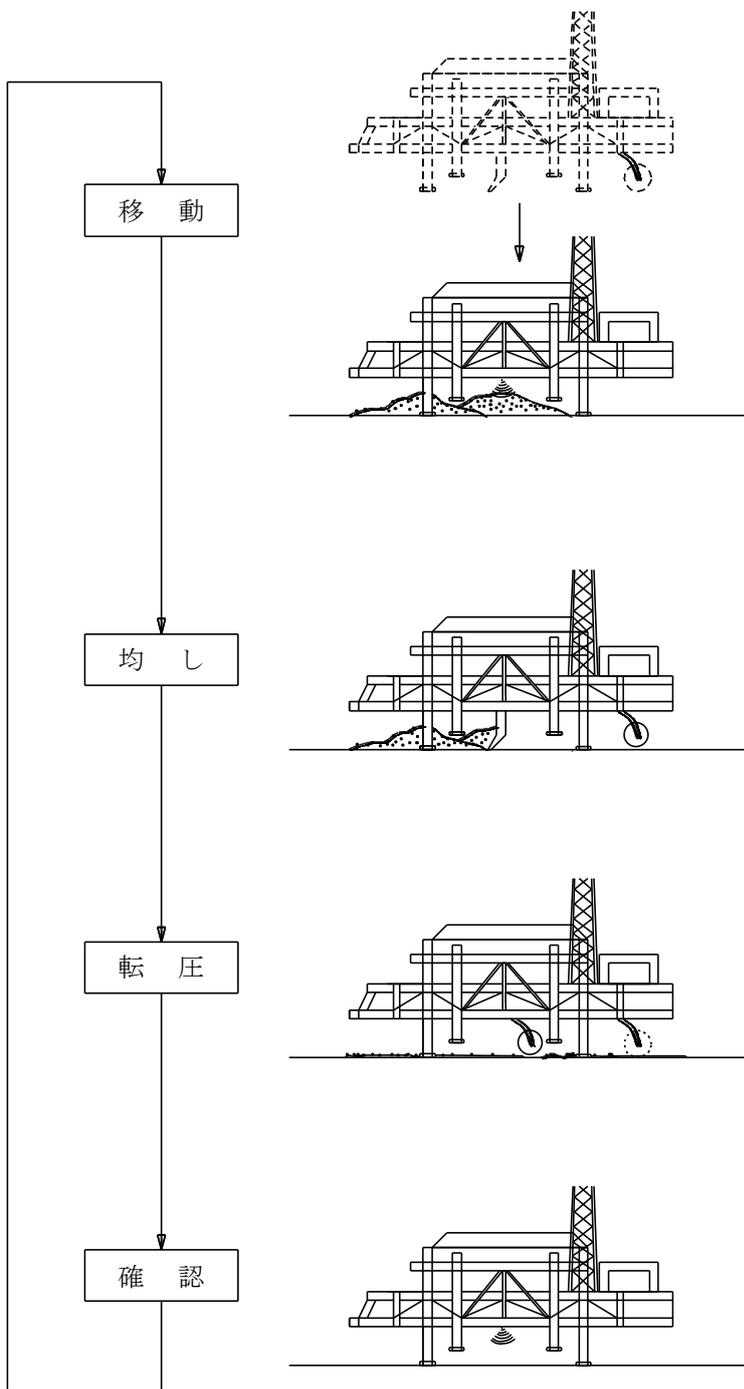
均し機を所定の位置まで運び、沈設します。地形測量器により捨石投入の不陸の凹凸状況を調べます。
